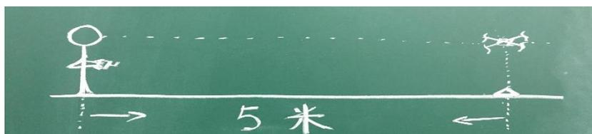
训练要求如上图，和飞行器保持 5 米左右距离，飞行器控制在目视高度，能平稳起飞和垂直降落。
